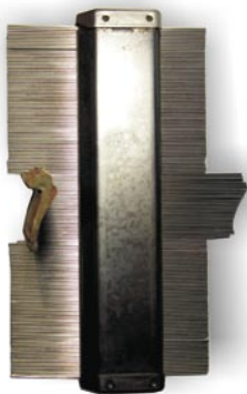
Figura 15. Aplicación del perfilador en piezas incompletas.
