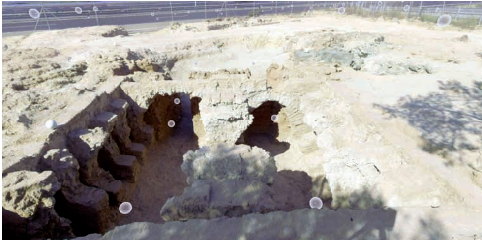
Figura 3. Nube de puntos donde se observan las diferentes posiciones del escáner.
